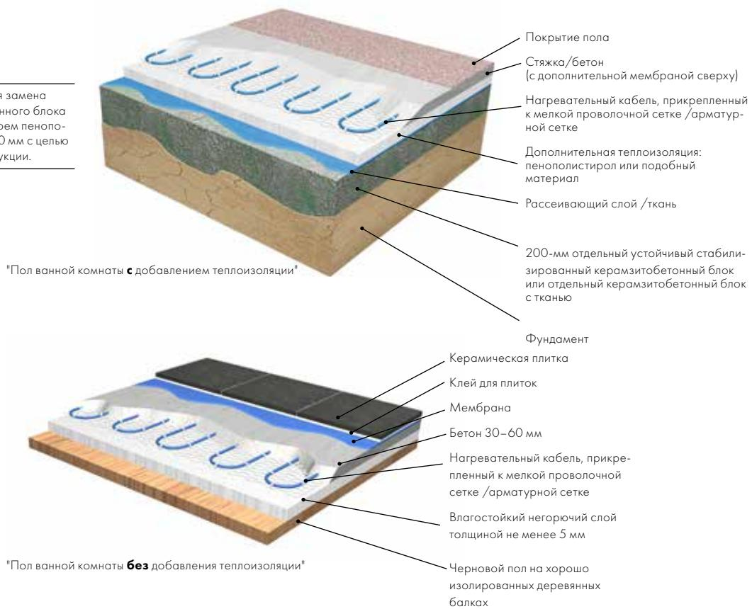
Стяжка/бетон должны укладываться таким образом, чтобы пол имел уклон в направлении выпуска, что обеспечит стекание воды. В ванной комнате необходимо, чтобы стяжка, или бетонный слой, были однородны и не имели пор. Относительно заливки бетона см. предыдущую страницу.
